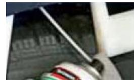
内部への注入の際にはストローノズルに付け替えて使用します
