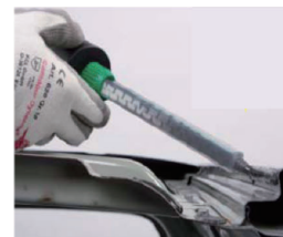
鋼板用接着剤(2液タイプ) TEROSON EP 5055
